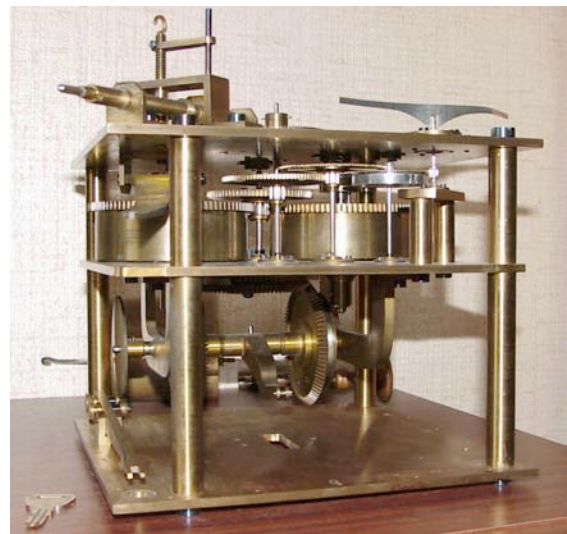
Abb. 9: Originales Aufzugswerk einer Lössluhr mit mehreren Federhäusern 35
