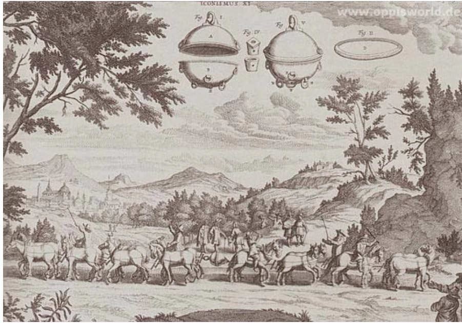
Abb.2: Der „Magdeburger- Halbkugel-Versuch“ Otto von Guericke als Stich aus seinem 1672 in Amsterdam erschienenen Buch: "Experimenta Nova Magdeburgica de Vacuo Spacio" 13
