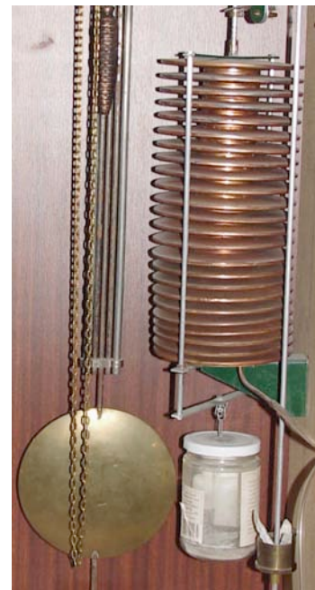
Abb. 8: Blasebalgähnlicher Blechzylinder als Motor der Lössl Wanduhr 31
