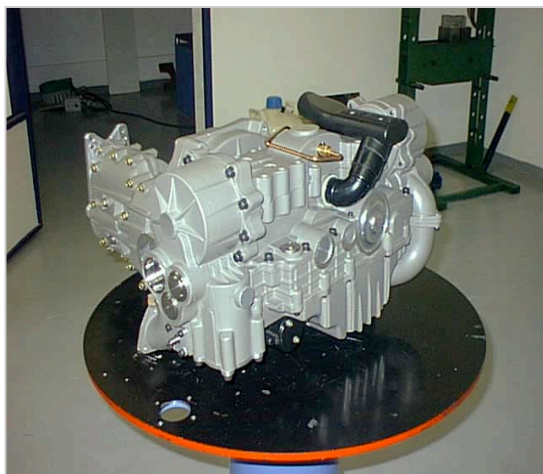
Abb. 17: Luftdruckmotor von Nègres umweltfreundlichen AirCar 80
