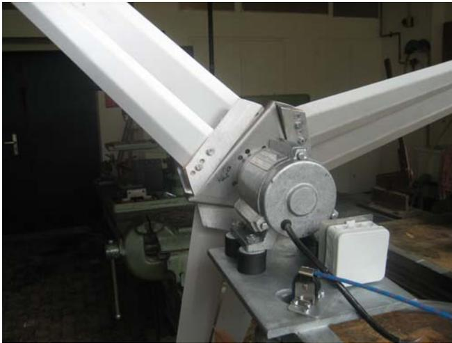
Detail Generator mit Anschlussdose für die elektrische Verschaltung des Generators und der Lampen.
