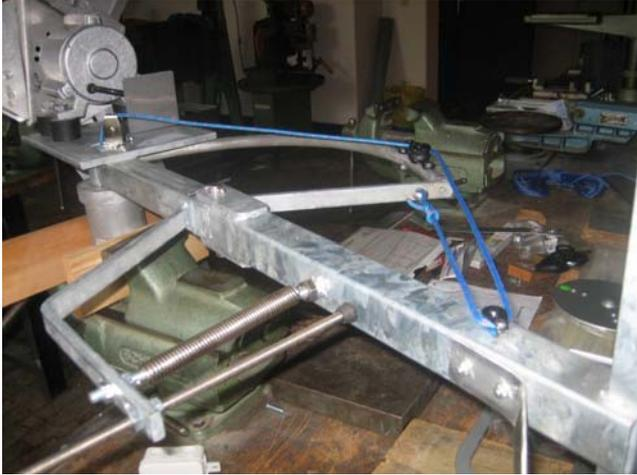
Details der automatischen Sturmsicherung, bei der die Flügel bei zu großen Windgeschwindigkeiten aus dem Wind gedreht werden.
